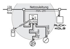
Durch das Einhalten der minimalen Kabellängen vermeiden Sie das Risiko von Störungen, die induktive Lasten wie Schütz- oder Magnetventilspulen oder Pumpen verursachen können. Sie haben auch den Vorteil, das spätere Änderungen an der Anlage leichter durchführbar sind.
